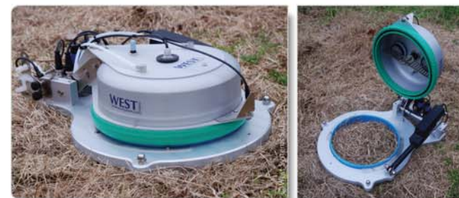
Camera di accumulo automatica per il monitoraggio di N 2 O, CO 2 e CH 4
